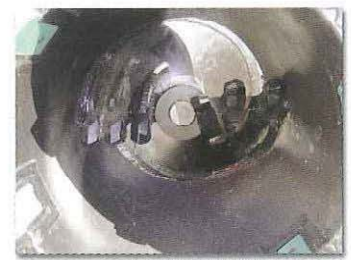
螺旋状の爪(スパイラルクロー)
